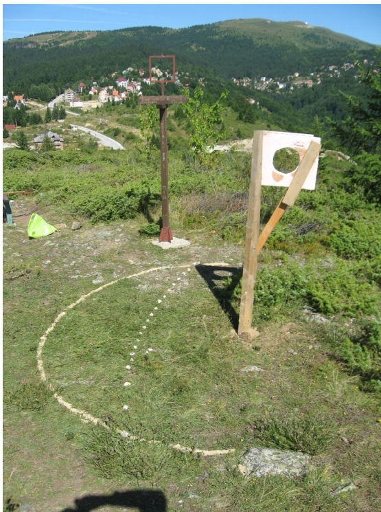
СЛИКА 5. На стубу браон боје је показивач страна света са правоугаоним рамом у равни меридијана. Стуб (висине 167cm) и стиропор плоча (40cmx50cmx3cm) са кружним отвором (полупречника 10 cm) су коришћени да би се одредио (проверио) правац меридијана и пратила промена облика сенке плоче са кружним отвором у току дана.
