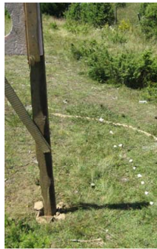
Слика 11. У току посматрања врх сенке смо бележили помоћу белих каменчића, најпре у интервалима по 30 минута а касније по 15 минута. Мерење је почело у 10h (лево) када је нацртан кружни лук са центром у подножју стуба. Полупречник тога лука је једнак дужини сенке стуба на почетку мерења, која је износила 160cm. Дужина сенке је постала најкраћа у интервалу између 12:45 и 13:00. Фотографија у средини је начињена у 12:45 када се сенка плоче свела на дебљу праву на којој се не препознаје кружни отвор. Потом се дужина сенке стуба повећавала а слика кружног отвора постепено добијала кружни облик. Десно је сенка у 15:15h.
