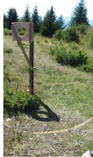
Слика 11. У току посматрања врх сенке смо бележили помоћу белих каменчића, најпре у интервалима по 30 минута а касније по 15 минута. Мерење је почело у 10h (лево) када је нацртан кружни лук са центром у подножју стуба. Полупречник тога лука је једнак дужини сенке стуба на почетку мерења, која је износила 160cm. Дужина сенке је постала најкраћа у интервалу између 12:45 и 13:00. Фотографија у средини је начињена у 12:45 када се сенка плоче свела на дебљу праву на којој се не препознаје кружни отвор. Потом се дужина сенке стуба повећавала а слика кружног отвора постепено добијала кружни облик. Десно је сенка у 15:15h.
