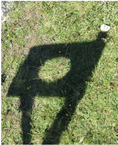
Слика 11. У току посматрања врх сенке смо бележили помоћу белих каменчића, најпре у интервалима по 30 минута а касније по 15 минута. Мерење је почело у 10h (лево) када је нацртан кружни лук са центром у подножју стуба. Полупречник тога лука је једнак дужини сенке стуба на почетку мерења, која је износила 160cm. Дужина сенке је постала најкраћа у интервалу између 12:45 и 13:00. Фотографија у средини је начињена у 12:45 када се сенка плоче свела на дебљу праву на којој се не препознаје кружни отвор. Потом се дужина сенке стуба повећавала а слика кружног отвора постепено добијала кружни облик. Десно је сенка у 15:15h.
