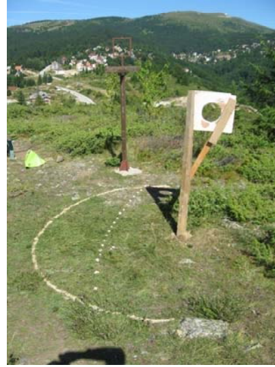
Слика 10. лево) Показивач страна света са правоугаоним рамом у равни меридијана на брду Сама буква на Копаонику. десно) Стуб (висине 167cm) и стиропор плоча (40cmx50cmx3cm) са кружним отвором (полупречника 10 cm), постављен да би се одредио правац меридијана и пратила промене облика сенке плоче са кружним отвором.
