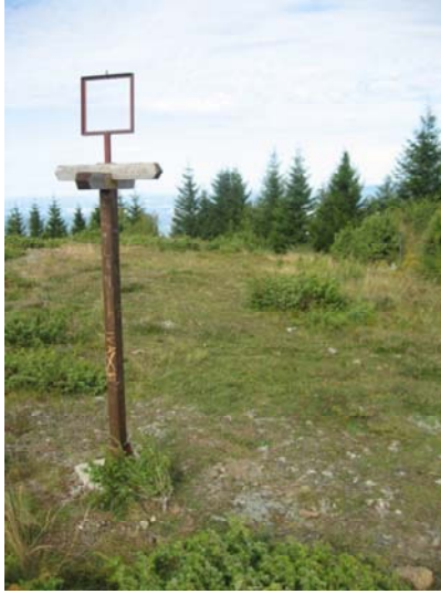
Слика 10. лево) Показивач страна света са правоугаоним рамом у равни меридијана на брду Сама буква на Копаонику. десно) Стуб (висине 167cm) и стиропор плоча (40cmx50cmx3cm) са кружним отвором (полупречника 10 cm), постављен да би се одредио правац меридијана и пратила промене облика сенке плоче са кружним отвором.
